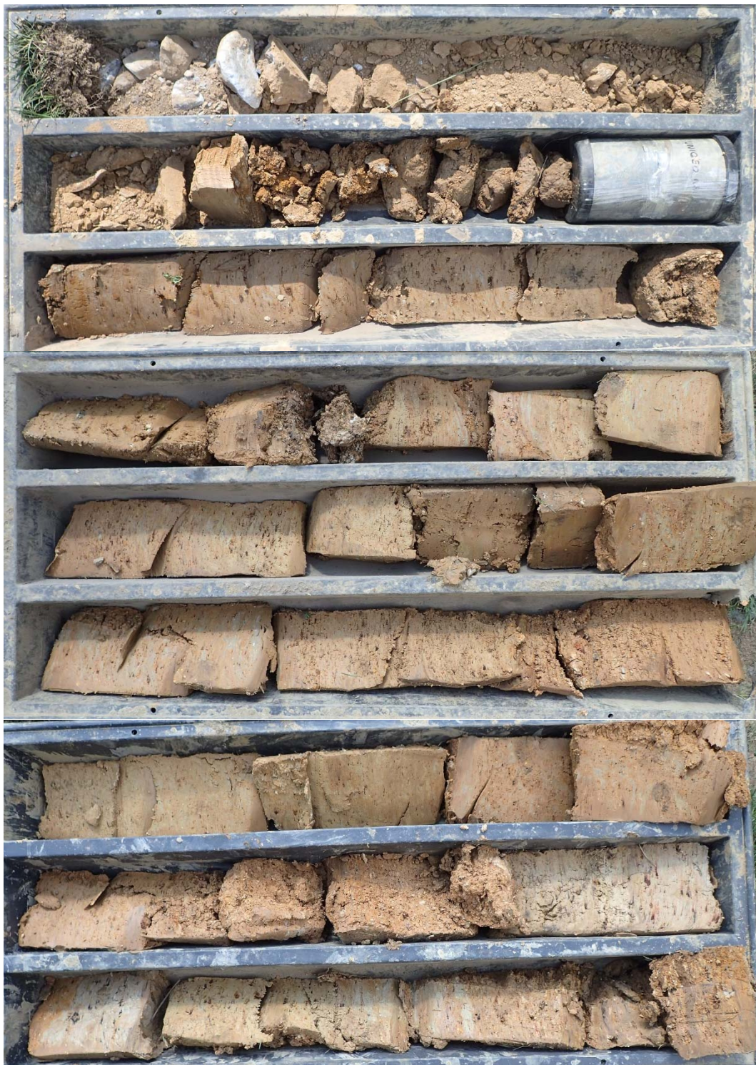
Foto 3: Geologický profil průzkumného vrtu PV-22.586
